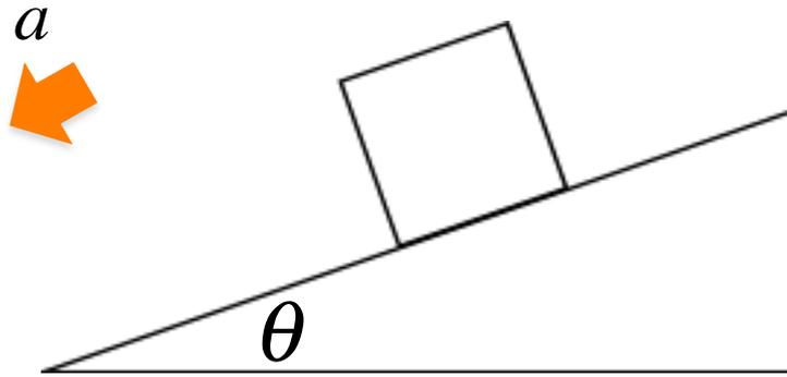
2. 質量  $m$  の物体が斜面を滑り降りる (摩擦力  $f$  あり)
