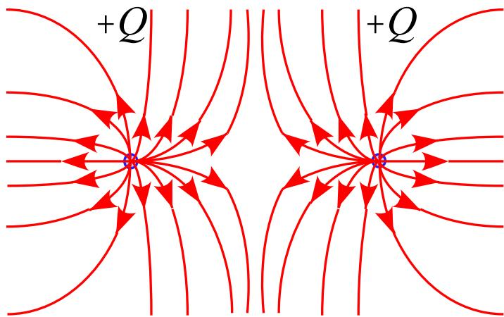
電気力線は2ヶ所の「 $+Q$  の点電荷」から出ていきます。お互いに電気力線は交わること無く反発し合うように広がっていきます。
