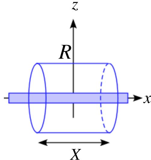
図のような円筒を閉曲面として考える
